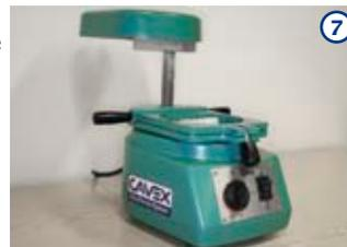
⑦ Drehen Sie das Heizelement wieder nach hinten und lassen Sie den Vakuummotor ca. 40 Sekunden laufen. Warten Sie nach dem Ausschalten des Vakuummotors noch 2 Minuten, bevor Sie den Rahmen öffnen.
