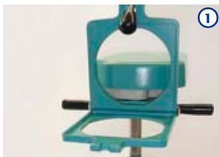
① Drehen Sie das Heizelement nach hinten und öffnen Sie den Rahmen.
