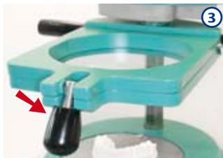
③ Legen Sie die „Bleach“-Tiefziehfolie in den Rahmen ein. Schließen Sie den Rahmen und ziehen Sie den schwarzen Knopf fest an. Schieben Sie den Rahmen anschließend ganz nach oben.
