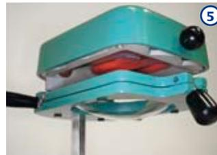
⑤ Die Bleach-Tiefziehfolie wird jetzt erwärmt und biegt sich langsam durch (siehe TIPP 1). Sorgen Sie dafür, dass sich das Gipsmodell in der Mitte der Vakuumplatte befindet (Platte mit Öffnungen)
