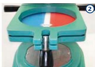
② Placez la plaque thermoformable Mouth protector, le côté transparent orienté vers le haut, dans le support. Fermez le support et serrez bien le bouton noir.
