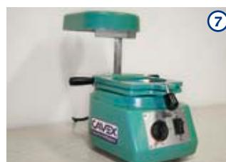
⑦ Tournez à nouveau la tête chauffante vers l'arrière et laissez tourner le moteur d'aspiration durant environ 40 secondes. Après avoir éteint le moteur d'aspiration, attendre encore 2 minutes avant d'ouvrir le support.
