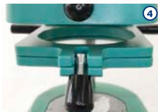
④ Drehen Sie das vorgeheizte (deutlich glühende) Heizelement über den Rahmen.
