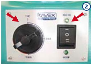
② Stellen Sie den Timer auf ca. 3 Minuten ein. Lassen Sie das Gerät 2 Minuten vorheizen. Die „HEATING“ (-) Lampe leuchtet jetzt.
