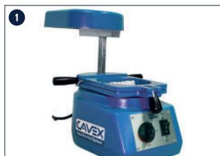
Drehen Sie das Heizelement nach hinten. Platzieren Sie den Rahmen, der die Platte hält, leicht oberhalb des Teils mit den Löchern.
