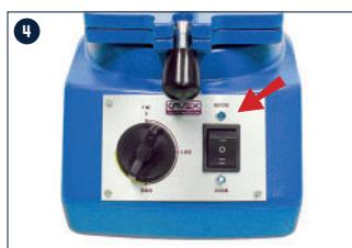
Stellen Sie den Druckknopf auf die Position 'HEATING' und drehen Sie den Timer kräftig. Die Lampe darüber leuchtet auf. Stellen Sie den Timer auf mehr als 4 Minuten.
