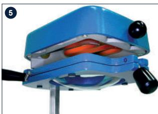
Platzieren Sie das Zahnmodell mittig auf dem Teil mit den Löchern. Die Bleach-Tiefziehplatte wird erhitzt und sinkt langsam ab. Achten Sie darauf, dass das Zahnmodell mittig auf der Vakuumplatte mit Löchern liegt.
