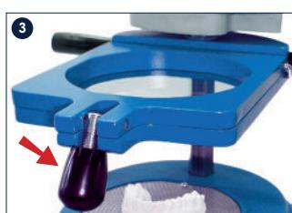
Schließen Sie den Rahmen und ziehen Sie den schwarzen Knopf fest. Schieben Sie den Rahmen dann ganz nach oben, bis er das graue Teil berührt. Drehen Sie das Heizelement über den Rahmen.
