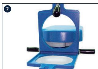
Entfernen Sie die blaue Folie von der Bleach-Tiefziehplatte und setzen Sie sie anschließend in den Rahmen ein.
