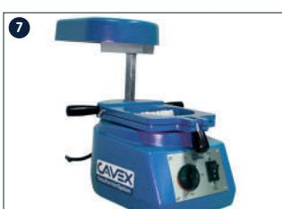
Lassen Sie das Gerät 30 Sekunden tiefziehen, schalten Sie dann die Vakuumpumpe aus und lassen Sie es etwa 2 Minuten abkühlen. Lösen Sie anschließend den Rahmen und entnehmen Sie vorsichtig die Platte mit dem Zahnmodell.
