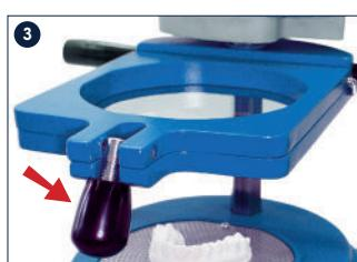
Schließen Sie den Rahmen und ziehen Sie den schwarzen Knopf fest. Schieben Sie den Rahmen dann ganz nach oben bis zum grauen Teil. Drehen Sie das Heizelement über den Rahmen.
