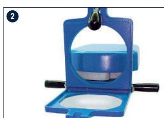
Entfernen Sie die blaue Folie von der Schienen-Tiefziehplatte und setzen Sie diese anschließend in den Rahmen ein.
