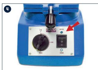
Stellen Sie den Druckknopf nach oben auf die Position 'HEATING' und drehen Sie den Timer kräftig. Die Lampe darüber leuchtet auf. Stellen Sie den Timer auf mehr als 4 Minuten.
