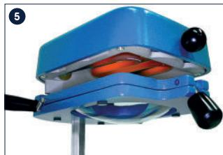
Platzieren Sie das Zahnbogenmodell in der Mitte des Teils mit den Löchern. Die Schienen-Tiefziehplatte wird sich erwärmen und langsam durchhängen. Achten Sie darauf, dass das Zahnbogenmodell mittig auf der Vakuumplatte mit Löchern liegt.
