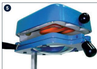
Placez le modèle de l'arc dentaire au centre de la partie avec les trous. La plaque thermoformable pour gouttière va chauffer et s'affaisser lentement. Assurez-vous que le modèle de l'arc dentaire est bien centré sur la plaque à vide avec trous.
